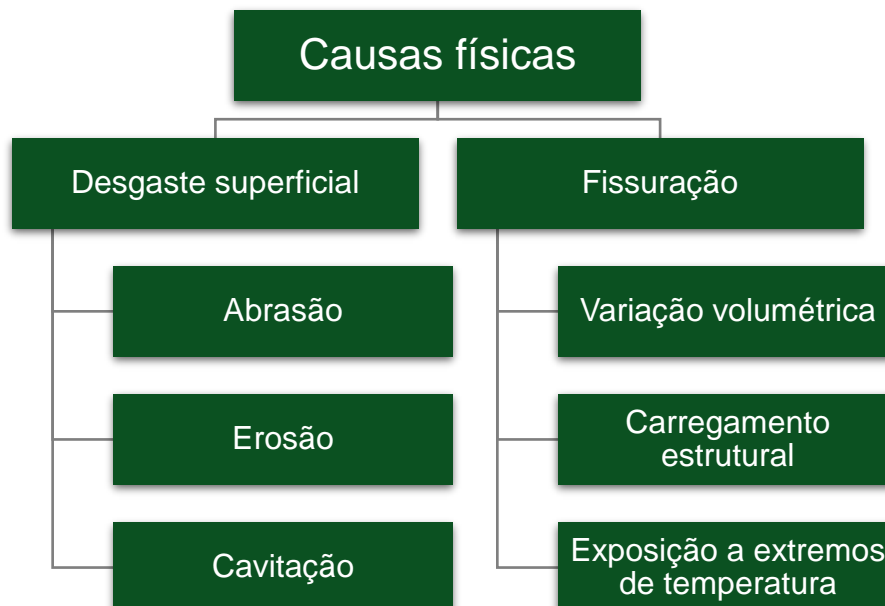
Figura 1 - Causas físicas da deterioração do concreto
