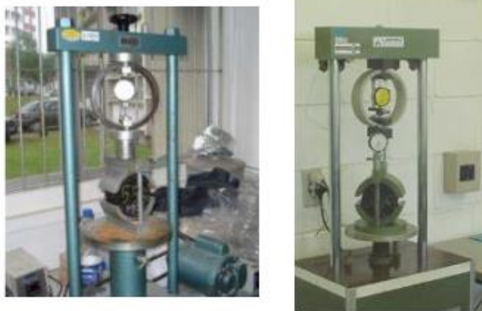
Figura 6 - Prensa Marshall, para ensaios de Estabilidade e Fluência
