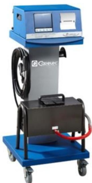
Aparelho usado para medir a concentração de material particulado presente na fumaça expelida pelos motores a diesel.
