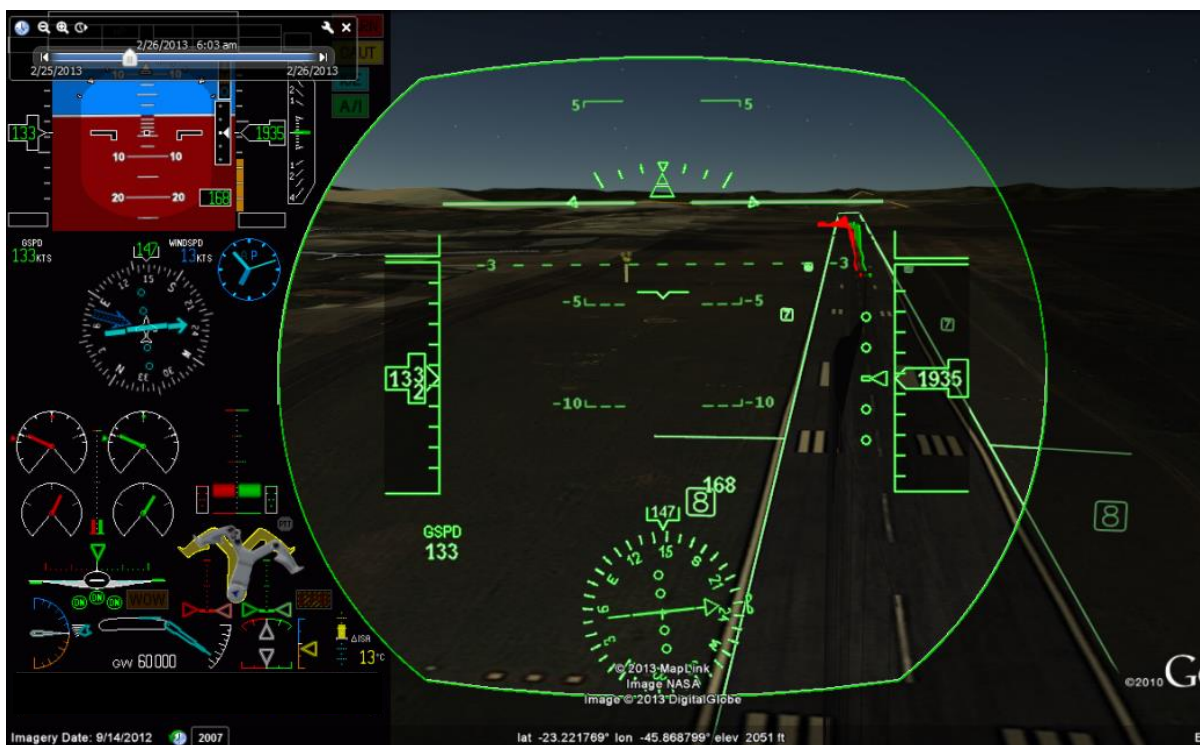
Figura 9. Visão do piloto como feita através de um dispositivo Head-Up Display .
