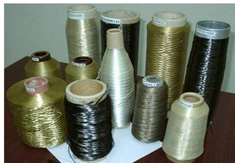
Imagem 2 – Fibras de carbono, aramida e vidro de alta resistência à tração constam das listas de itens sujeitos a controles de exportação porque têm aplicação em rotores de centrífugas para enriquecimento de urânio e em peças para mísseis. Para o cumprimento de tratados internacionais, serviços de Inteligência acompanham essas exportações.
