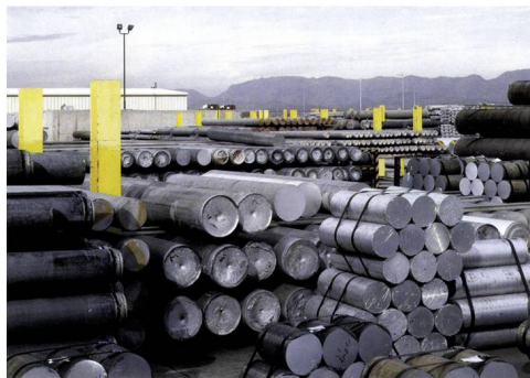
Imagem 3 – Esses tarugos de alumínio de alta pureza constam das listas de controle e têm sua exportação acompanhada por órgãos de Inteligência, uma vez que podem ser usados na fabricação de mísseis.
