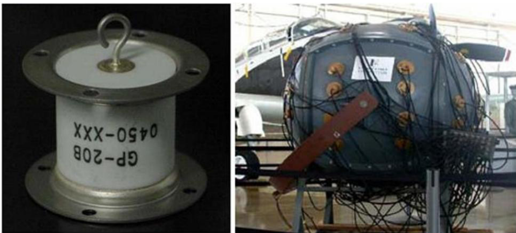
Imagem 1 – Um bem de uso dual, o centelhador à esquerda, com 4 cm de altura, é utilizado tanto em osciloscópios comuns de laboratório como em sistemas de disparo de armas nucleares. À direita, uma bomba com diversos centelhadores instalados. Por esse motivo, e visando ao cumprimento dos tratados internacionais, a exportação de centelhadores é acompanhada por serviços de Inteligência.
