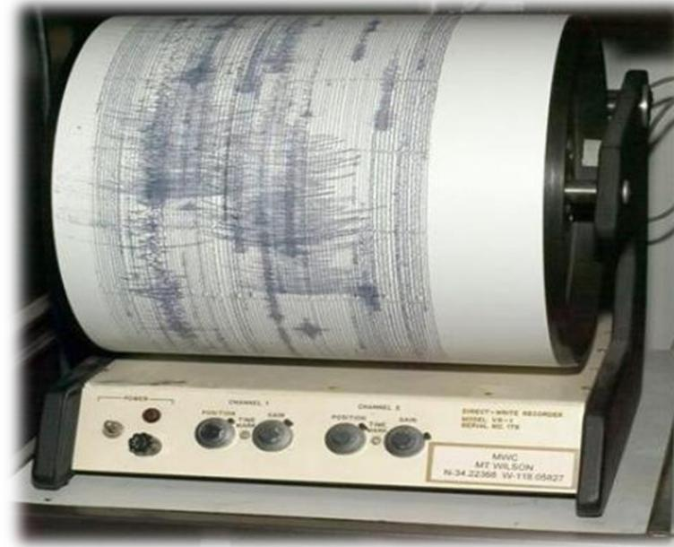
Sismógrafo é um aparelho que registra as ondas sísmicas, ou seja, a intensidade dos terremotos, em sismologia
