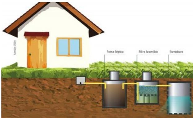
Resumidamente, a fossa séptica retém os sólidos, os decompõe e os trata em até 60%. Segue para o filtro anaeróbico passando por um novo processo em que a parte líquida pode atingir 95% de tratamento e, por fim, o sumidouro realiza a destinação do efluente no solo. Faz-se a manutenção periódica da fossa séptica, por empresas especializadas em limpeza de fossas, cujo resíduo deve ser encaminhado para estações de tratamento.
