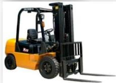
Equipamento cujo emprego principal é o transporte de mercadorias em paletes, otimizando, assim, o uso do espaço vertical em almoxarifados. Há vários tipos (elétricas, manuais, a combustão etc.) e modelos (frontais, laterais, trilaterais etc.). Necessita de operador especializado.
