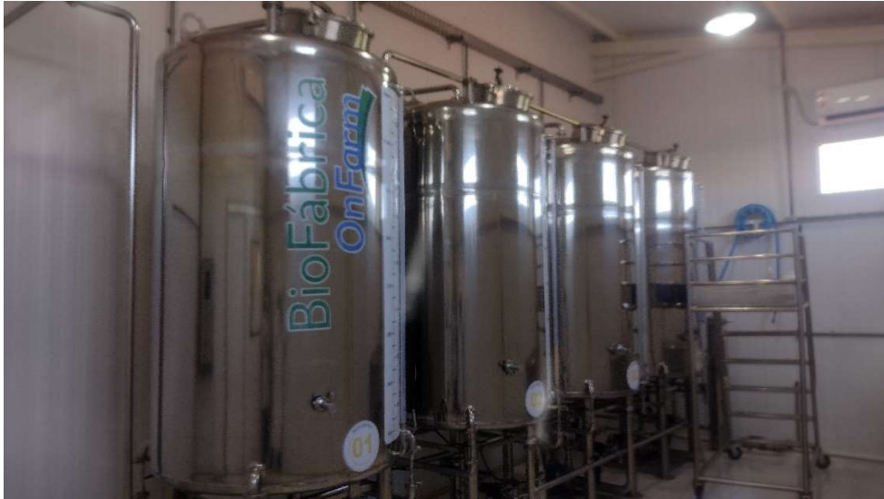
Figura 11. Tanques de fermentação em aço inoxidável com capacidade de 1500L cada.
