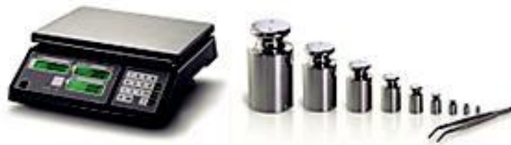
Figura 9 – Balança eletrônica (instrumento de medição indicador para medição de massa) e pesos-padrão (medidas materializadas)
