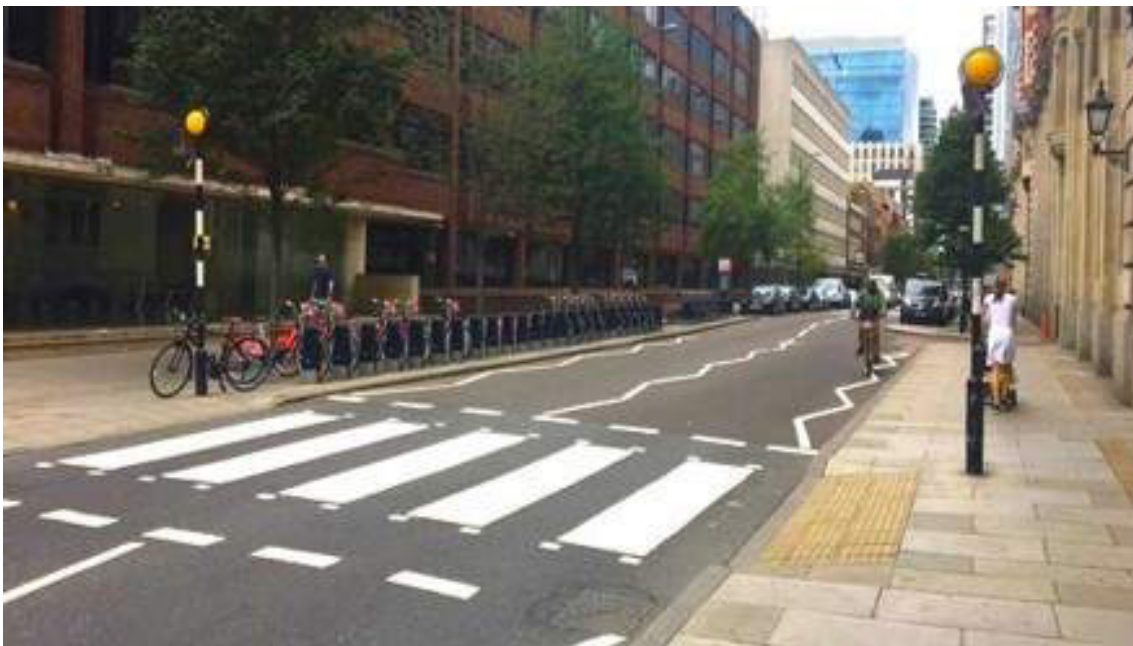
Fig. 24: Sinalização com piso tátil de alerta em área rebaixada da calçada em travessia de pedestres em Londres, Inglaterra. A presença dos postes com esferas amarelas sinaliza para os veículos a prioridade do pedestre e a necessidade de parar antes de cruzar a faixa.
