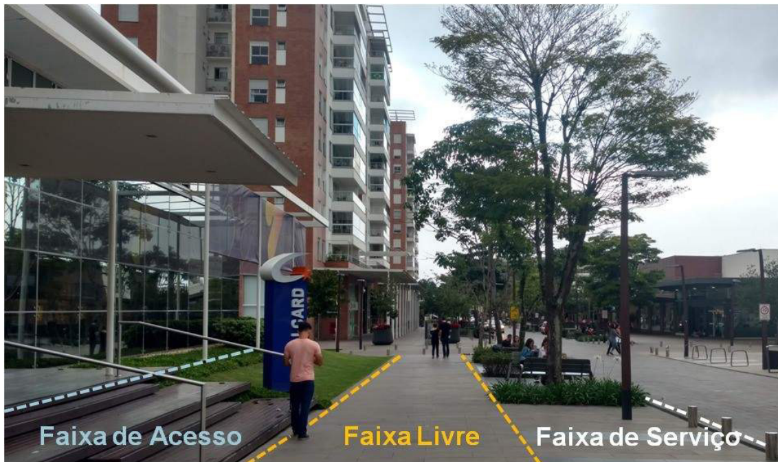
Fig. 6: Na Imagem de via compartilhada no bairro Pedra Branca, cidade de Palhoça, situada na Grande Florianópolis (SC) o espaço das calçadas está dividido em três faixas, FAIXA DE ACESSO destinada à entrada nos edifícios, FAIXA LIVRE destinado à passagem de pedestres, e FAIXA DE SERVIÇO destinado a implantação de mobiliário urbano, postes e vegetação. A via é compartilhada porque a faixa de rolagem de veículos está no mesmo nível da calçada delimitada por grelha de captação de águas pluviais e por balizadores.
