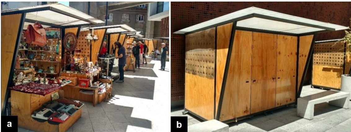
Fig. 36: As duas Imagens representam os quiosques modulares do Centro Cultural Gabriela Mistral em Santiago, no Chile. Notam-se como aspectos positivos que os módulos podem ser organizados em diferentes arranjos, permitindo a flexibilidade dos espaços. No primeiro quiosque existem duas alturas diferentes de mostruário, o que permite o alcance de uma pessoa de baixa estatura ou sentada. No quiosque seguinte é possível identificar um mostruário que permite o alcance apenas para uma pessoa em pé. No entanto por ser de vidro, permite a visualização também por uma pessoa sentada. b) Ilustra os módulos dos quiosques fechados e estacionados na faixa de acesso, sem obstruir o uso dos bancos ou a faixa de circulação onde antes, quando abertos, criavam uma relação direta com a área do passeio.
