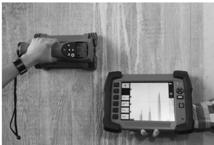
Figura 21 - Equipamento utilizado para localização de barras de aço.
