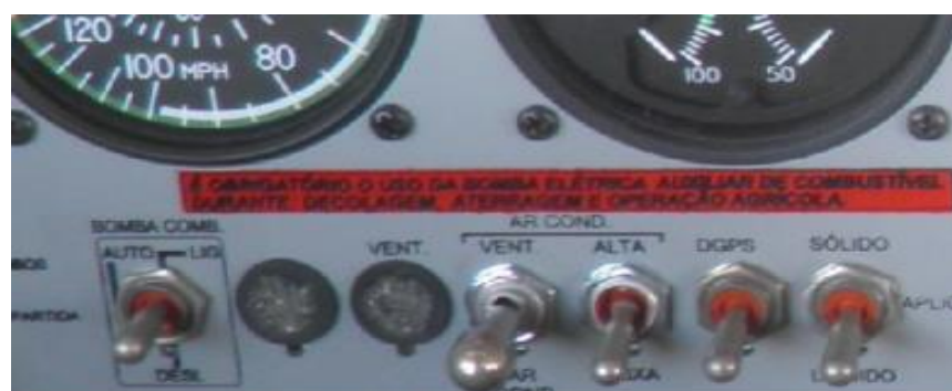
FIGURA 9: PLACA NO PAINEL DA AERONAVE INFORMANDO A OBRIGATORIEDADE DE SE MANTER A BOMBA ELÉTRICA LIGADA.
