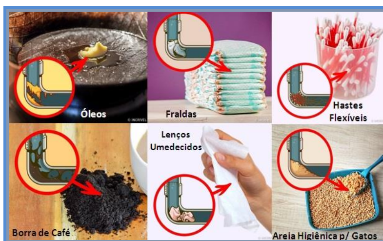
Figura 12: Imagens de resíduos que obstruem a canalização de esgoto.
