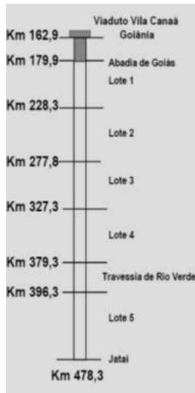
Figura 2 – Croqui da obra – BR-060/GO – Duplicação Goiânia - Jataí
