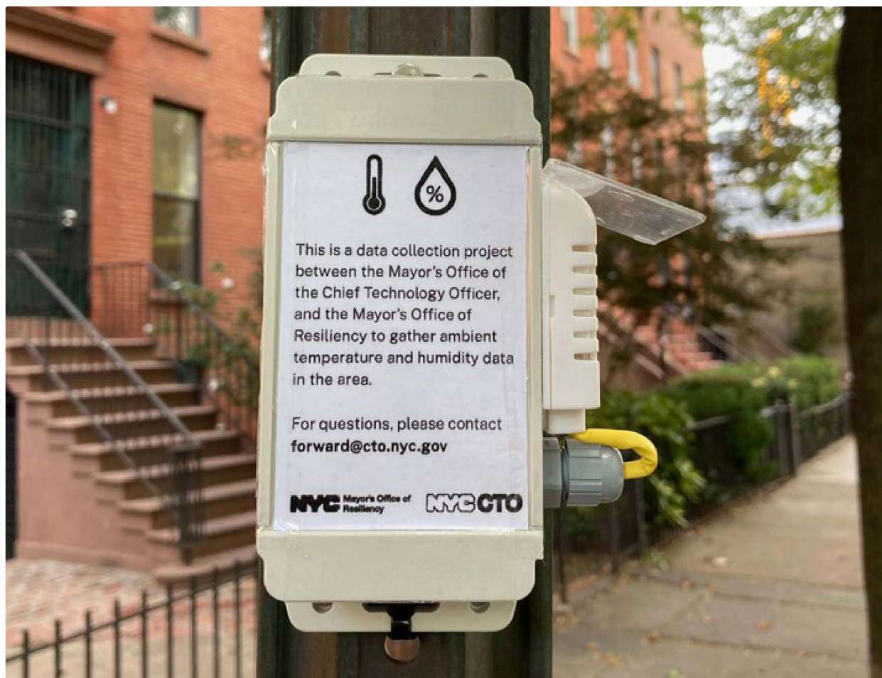
Sensor de temperatura e umidade instalado no Brooklyn para coleta de dados.
