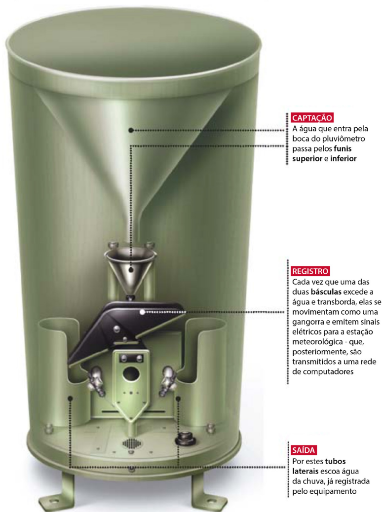
Figura 29: Detalhe dos componentes do pluviômetro. Fonte: Revista Escola.
