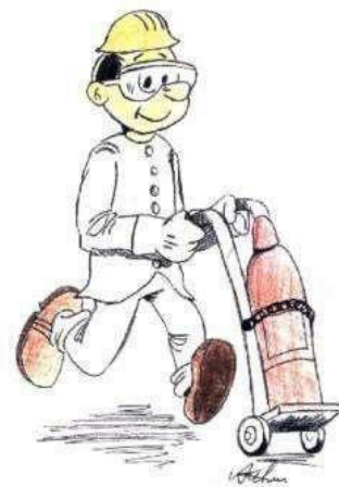
Transportar em carrinhos próprios e acorrentados
